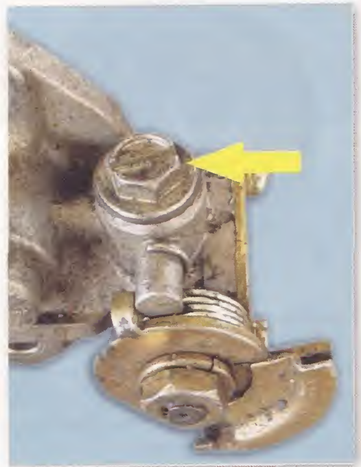
Drenaje de bomba autolube
